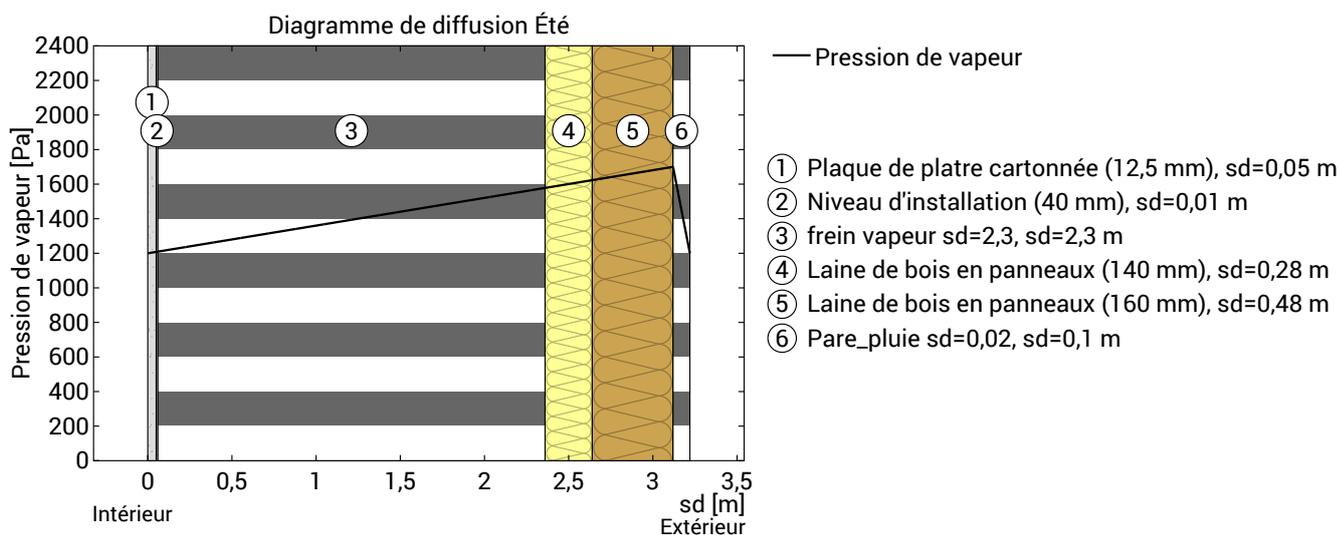
Composant exempt de condensat: Pour la réserve de séchage la masse d'évaporation maximale possible est calculé. Considérez le niveau qui présente le potentiel d'évaporation le plus faible pendant la période de rosée, à  $s_d=3,12 \text{ m}$ ;  $x=35,3 \text{ cm}$ :
