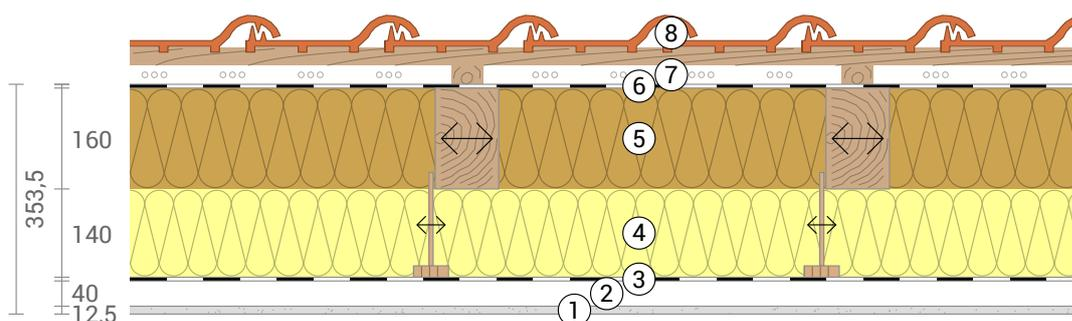
isolation entre et sous chevron naturelle laine de bois,  $R_{tot}=7,78 \text{ m}^2\text{K/W}$
