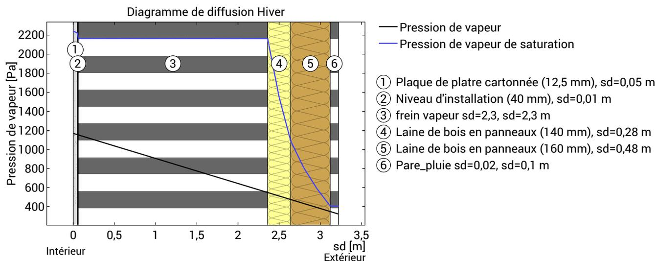
Dans les conditions supposées, la section examinée est exempte de condensation à l'intérieur du composant.
